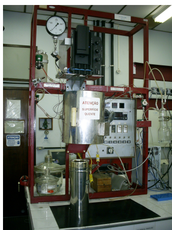
Figura 4 - Foto da Unidade MAT utilizada nos testes de co-pirólise de polipropileno e gasóleo.
