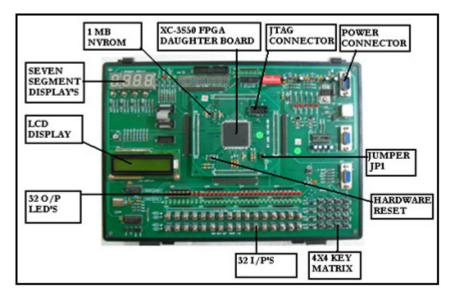
Fig.2 XC-3S50 FPGA VHDL TRAINER KIT
