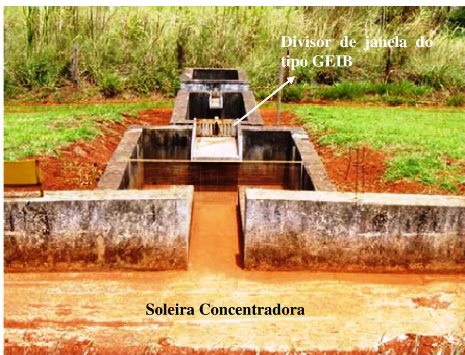
**Figura 2** - Sistema coletor de enxurrada em parcela experimental do Campo Experimental da FEAGRI/UNICAMP.
