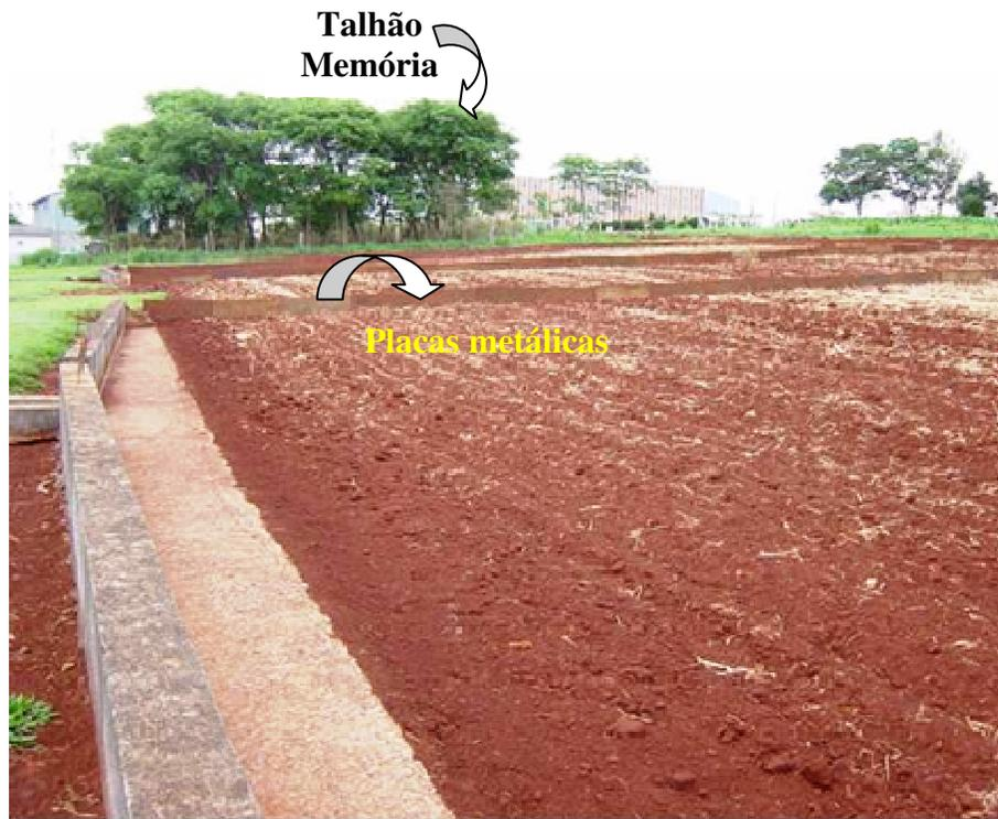
**Figura 5** - Parcelas fechadas por placas metálicas (nas laterais e parte superior) para contenção de enxurrada e prevenção de entrada de água de fora da parcela.
