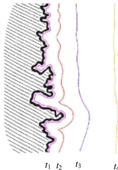
Figura 3.3.5: Camadas de difusão para vários tempos ( $t_1 < t_2 < t_3 < t_4$ ) nas proximidades do eletrodo de trabalho rugoso (parte riscada).
