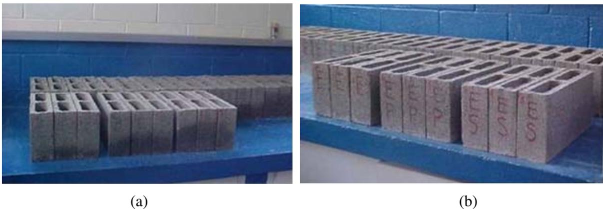
Figura 4.121 - Blocos vazados com os resíduos de *Eucalyptus grandis*: (a) blocos com umidade na parte inferior e (b) blocos sem umidade.
