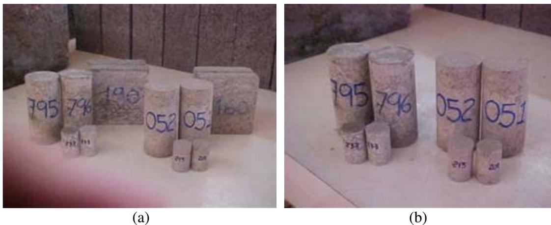
Figura 3.8 - Amostras (A), (B) e (C) na etapa de cura em ambiente de laboratório (a) e (b).
