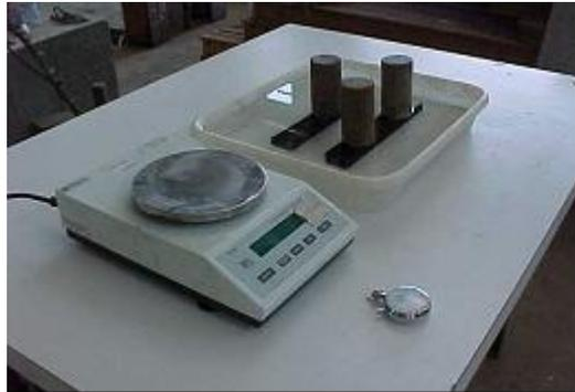
Figura 3.13 - Execução do ensaio de absorção de água por capilaridade dos compósitos.
