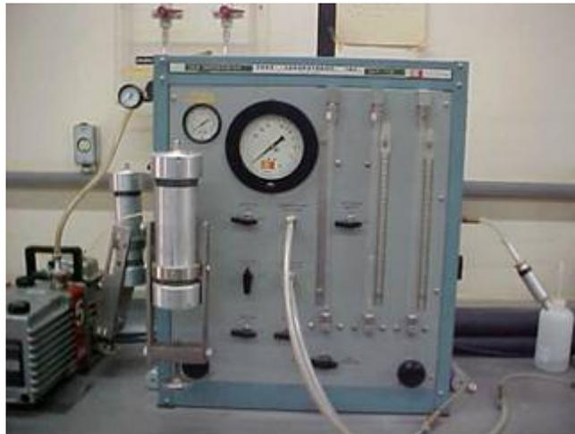
Figura 3.14 - Equipamento denominado *permeabilímetro* usado para medir a permeabilidade por intrusão do gás nitrogênio (N<sub>2</sub>).
