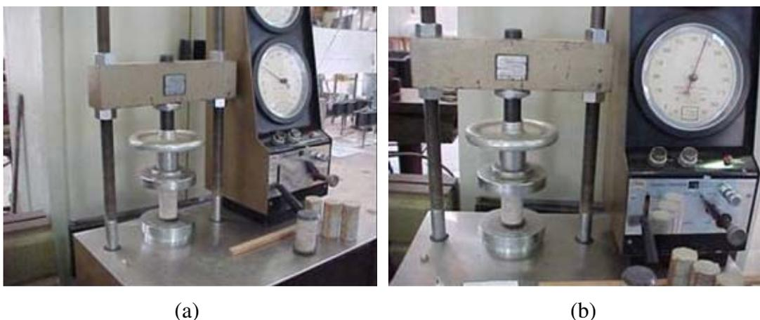
Figura 3.12 - Esforços de compressão axial simples em amostras cilíndricas (a) e (b).
