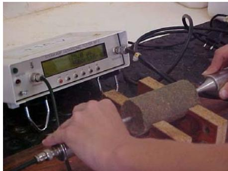
Figura 2.5 - Ensaio não destrutivo (END) através da utilização da propagação de ondas ultra-sônicas em compósitos cimentícios à base de resíduos vegetais.
