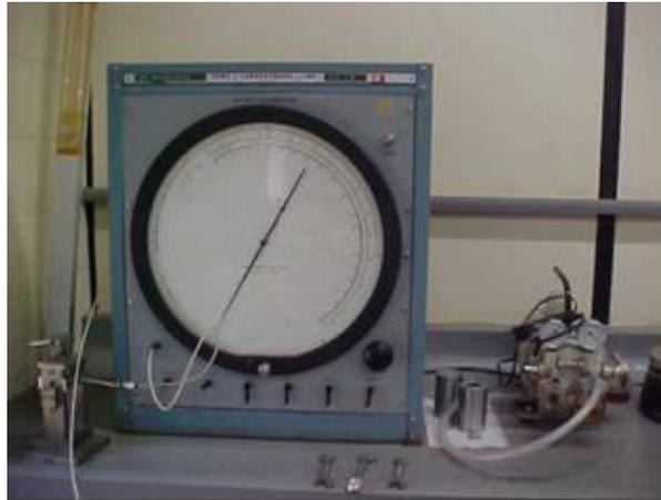
Figura 3.15 - Equipamento denominado *porosímetro* utilizado para medir a porosidade por intrusão do gás nitrogênio (N<sub>2</sub>).
