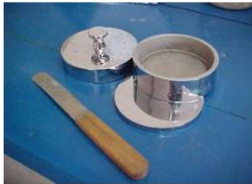
Figura 3.9 - Dispositivos do ensaio de retenção de água de acordo com a norma NBR-13277.
