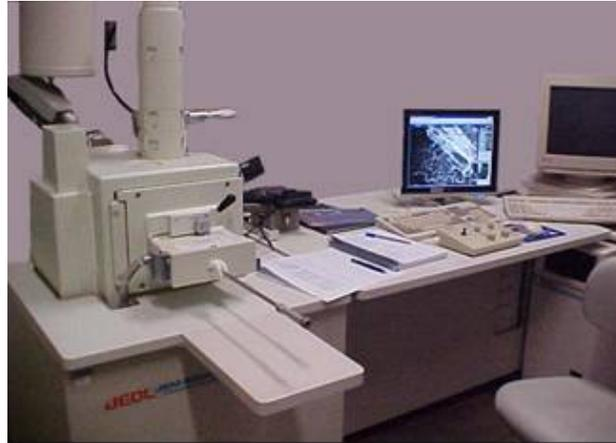
Figura 3.17 - Microscópio eletrônico de varredura LV-SEM (modelo JSM-5900LV).
