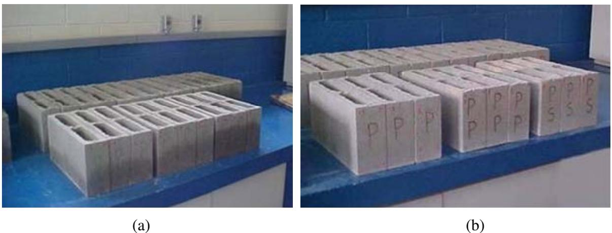
Figura 4.122 - Blocos vazados com os resíduos de *Pinus caribaea*: (a) blocos com umidade na parte inferior e (b) blocos sem umidade.
