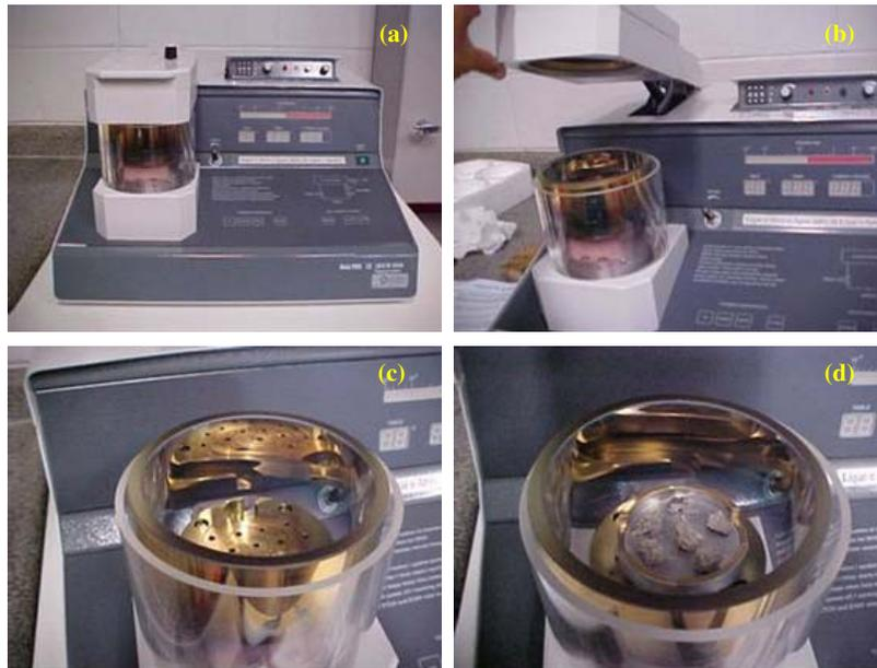
Figura 3.16 - Dispositivo para deposição de filme fino a vácuo (ouro ou carbono) sobre a amostra denominado *Sputtering*: (a) perspectiva geral (b) abertura da câmara (c) câmara vazia (d) câmara com o porta-amostra.
