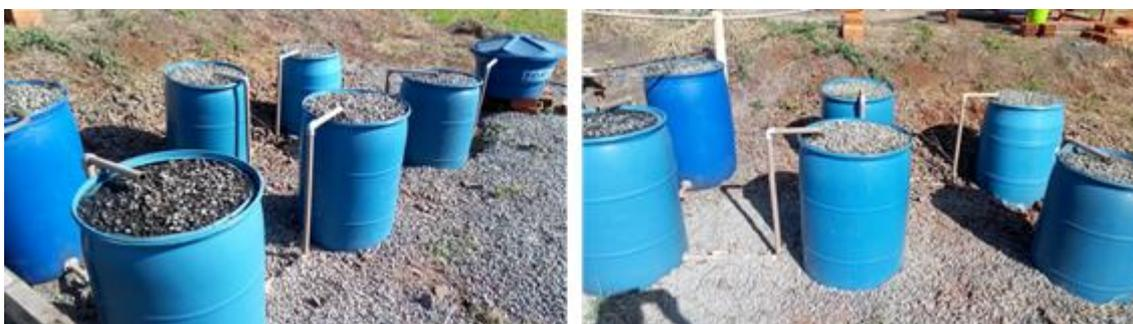
**Figura 1.** Sistema de tratamento de efluentes de esgoto doméstico em filtros anaeróbios.
