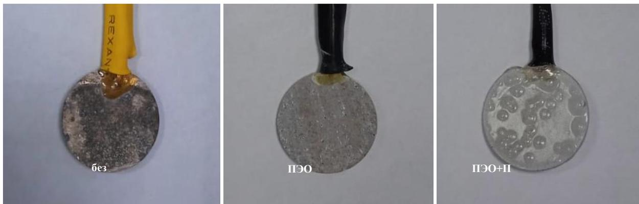
Рис. 3 – Фотографии образцов после коррозионных испытаний
