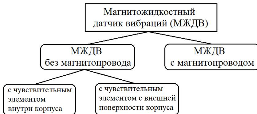
Рис. 1 – Магнитожидкостный датчик вибраций
