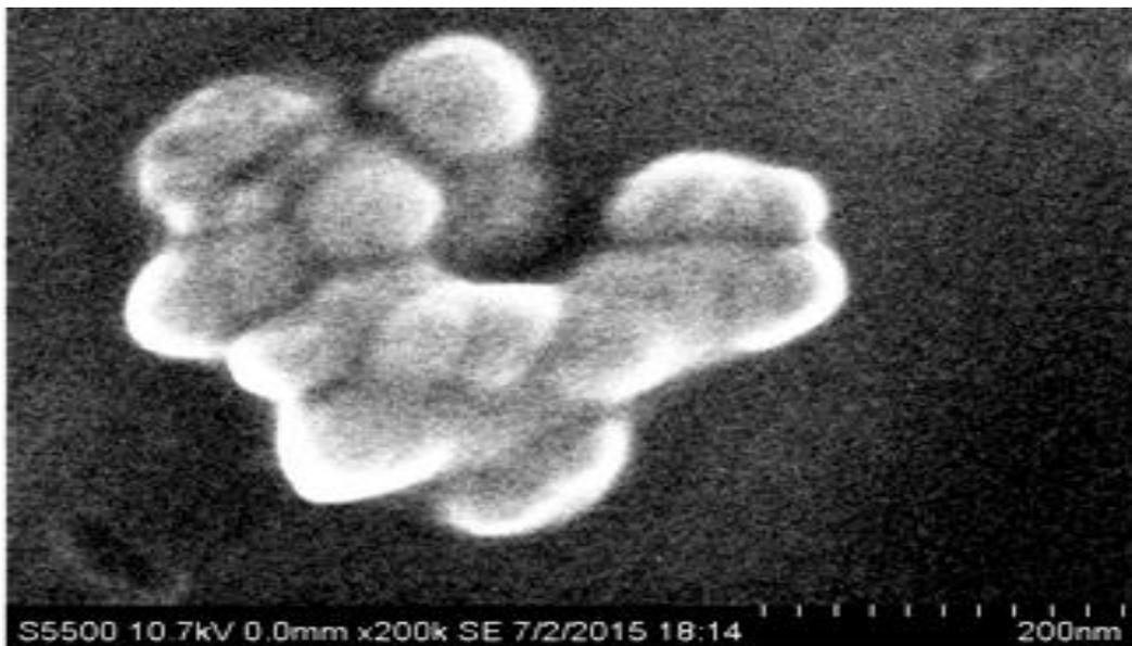
Рис. 4 – Электронно-микроскопический снимок частиц сажи судового дизеля 6ЧН 24/36 при нагрузке 50% от  $N_{eном}$
