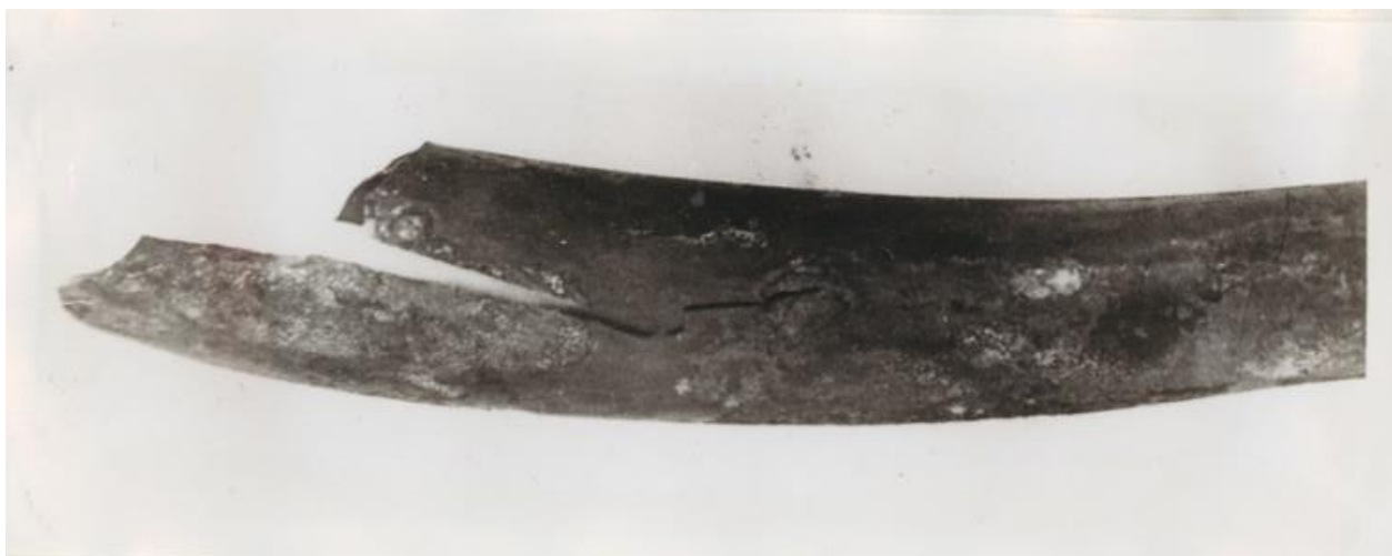
Рис. 1 – Общий вид трубы ПГ, потерявшей герметичность после засоления второго контура
