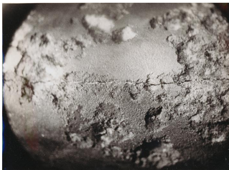
Рис. 3–Локальные коррозионные поражения трубы ПГ в области испарительного участка
