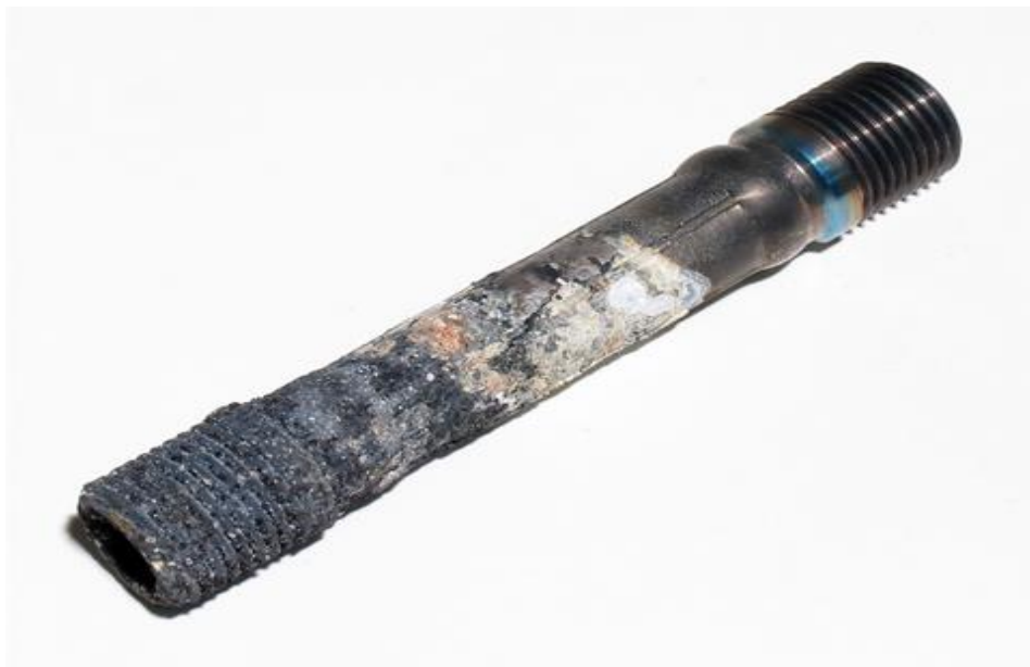
Рис. 7—Образец после 500 ч испытаний при температуре 200°C (часть, находившаяся в среде кристаллических солей, покрыта слоем отложений продуктов коррозии)
