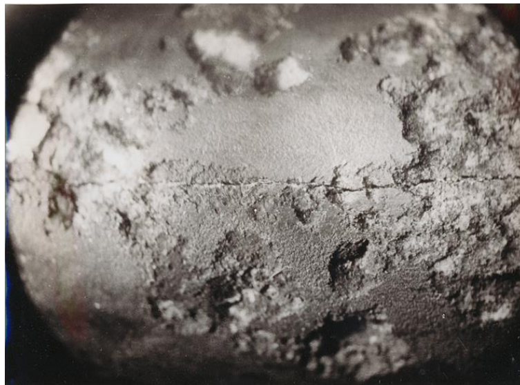
Рис. 2 – Локальные коррозионные поражения трубы ПГ в области испарительного участка
