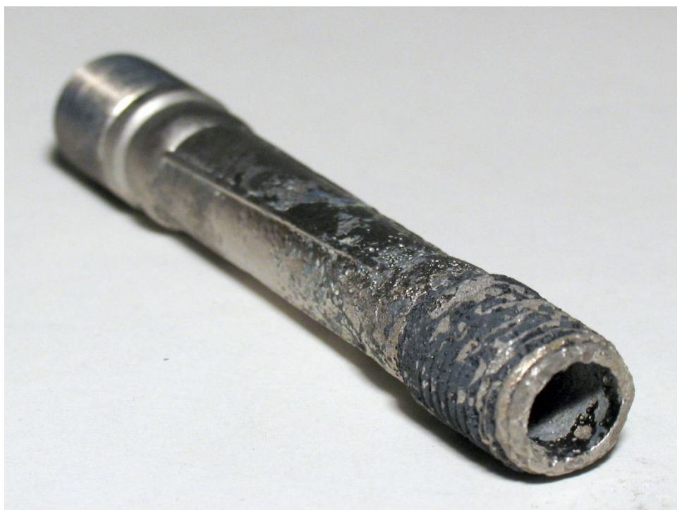
Рис. 8—Образец после 500 ч испытаний при температуре 400°C (слой продуктов коррозии удалён травлением смесью азотной и плавиковой кислот)
