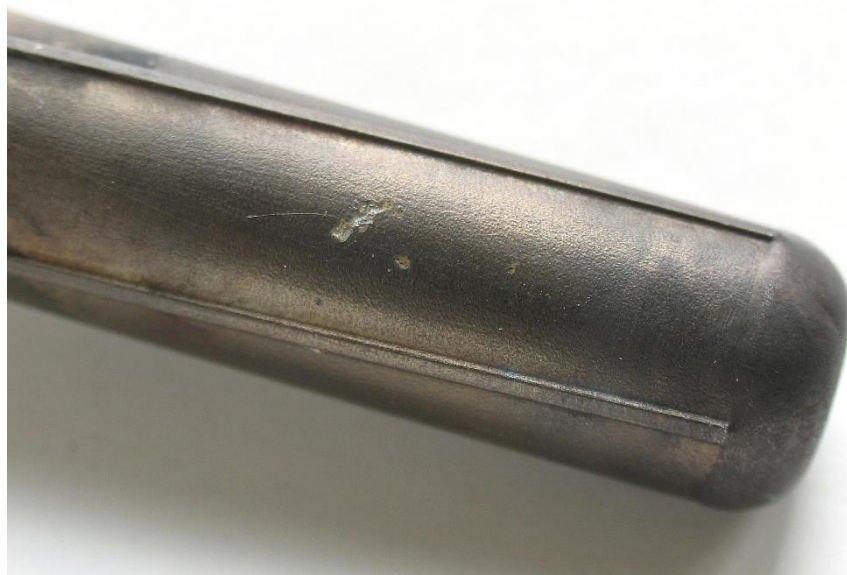
Рис. 5 – Питтинги на образце после испытаний
