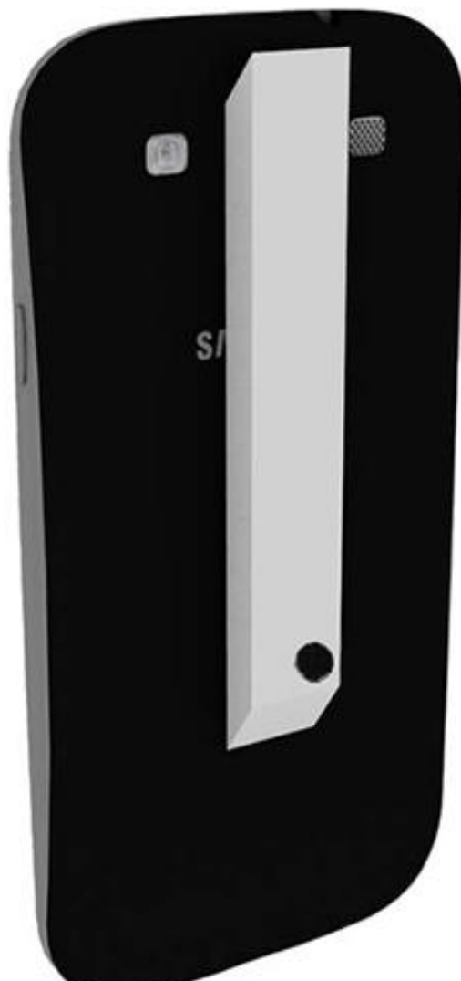
Рис. 3 – Мини-спектрометр укрепленный на смартфоне
