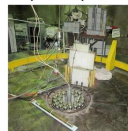
Рис. 7. Ампула загруженная в канал реактора ИВГ-1.М и подключенная к стенду ЛИАНА
