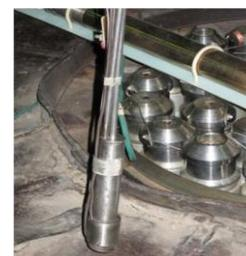
Рис. 6. Активная ячейка с исследуемым образцом
