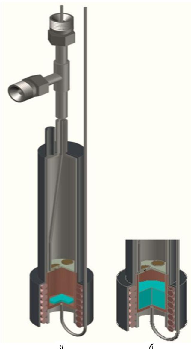
Рис. 4. Вид ампульного устройства: а — с литиевой КПС; б — с жидким литием
