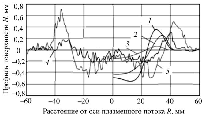
Рис. 15. Сопоставление расчётных (1, 2 — 1,9 МДж/м<sup>2</sup>, 100 атм; 3 — 1,6 МДж/м<sup>2</sup>, 30 атм) и экспериментальных данных (4 — 1,6 МДж/м<sup>2</sup>, 2,3 атм; 5 — 1,9 МДж/м<sup>2</sup>, 3,0 атм) о профиле поверхности стального образца, 25 пусков
