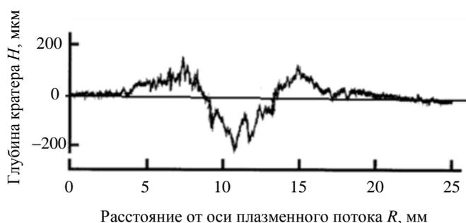
Рис. 8. Профиль поверхности алюминиевого образца после облучения плазмой на установке МК-200
