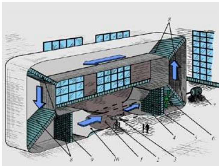
Рис. 2 – Принципиальная схема аэродинамической трубы
