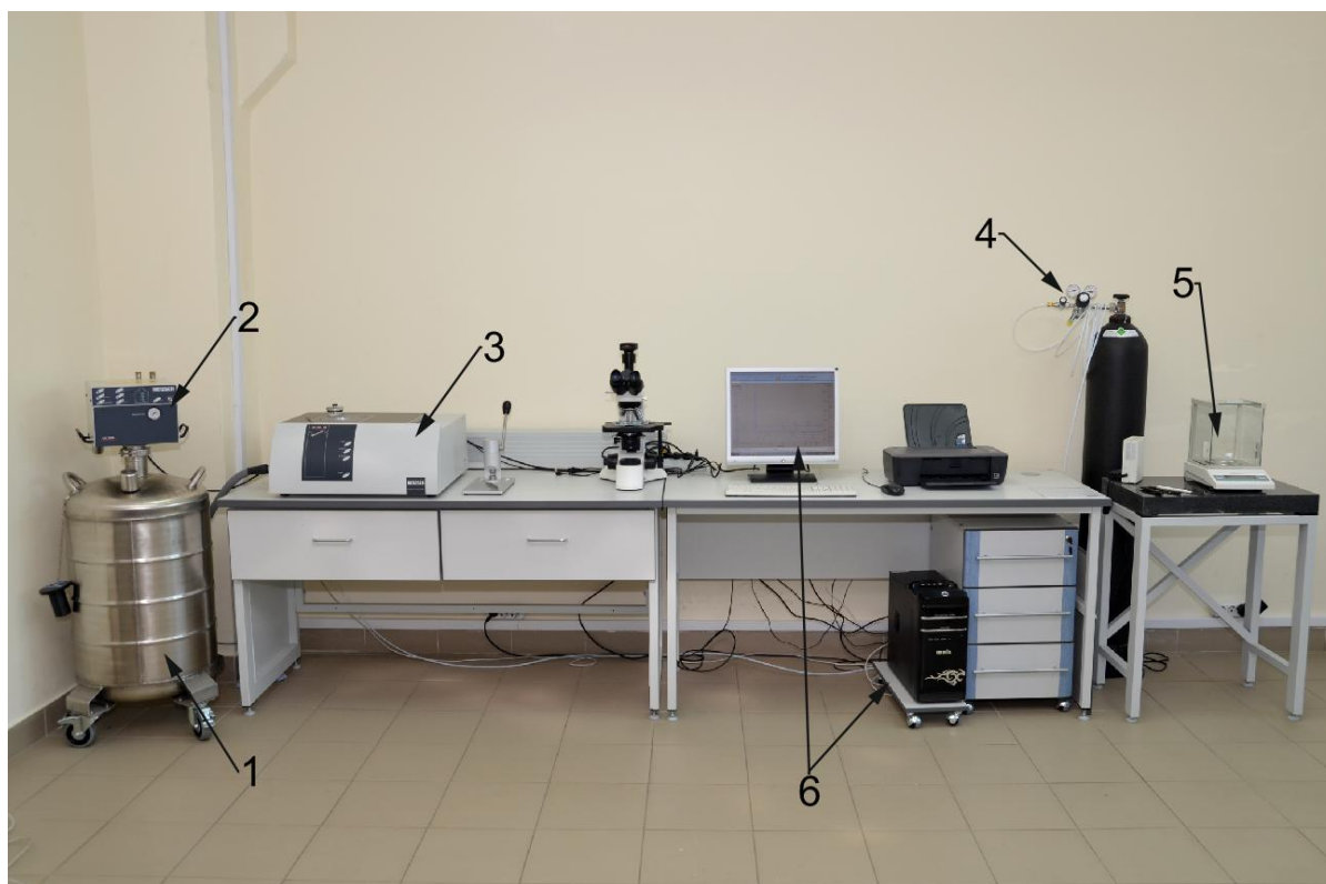
Рис. 2 – Общий вид стенда: 1 – сосуд Дьюара; 2 – система подачи жидкого или газообразного азота; 3 – DSC 204 F1 (дифференциальный сканирующий калориметр); 4 – система подачи продувочных газов; 5 – аналитические весы; 6 – компьютер с программным комплексом для управления калориметром и обработки полученных данных.
