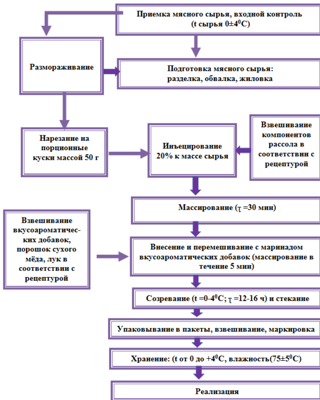
Рис. 1 – Технологическая схема производства шашлыка «Пикантный» с внесением порошка сухого мёда
