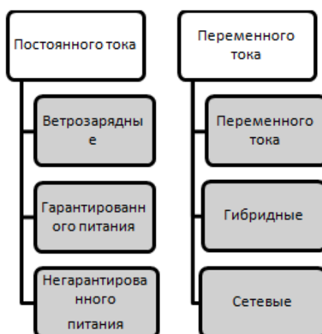
Рис. 1 – Классификация ветроэлектрических установок (ВЭУ)
