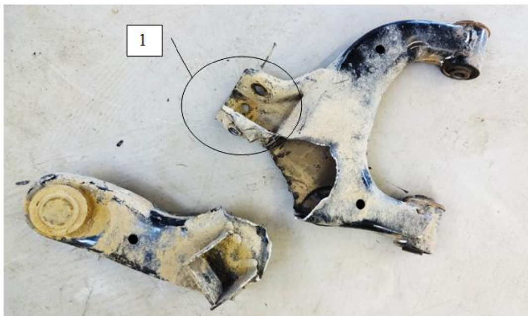
Рис. 1 – Разрушенный рычаг подвески
