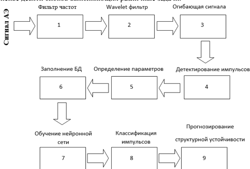
Рис. 2 – Принципиальная схема ПО выявления и классификация импульсов в сигнале АЭ с использованием подходов нелинейной динамики и искусственного интеллекта, при диагностики структурной устойчивости материалов
