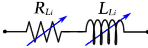
Рис. 6 – Эквивалентная электрическая схема для подъемной силы, приложенной к лопасти
