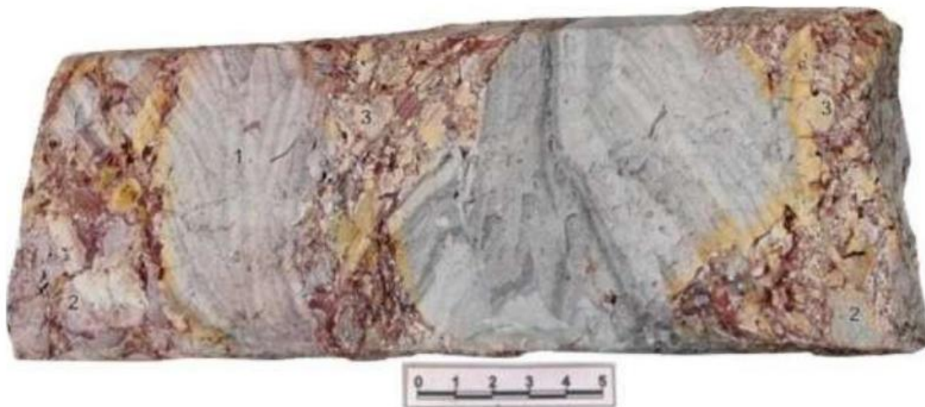
Рис. 11 – Ресилифицированные порода с реликтовой конгломерат-брекчиевой текстурой (каолинизированные обломки алевро-аргиллита (1) и ресилифицированная до каолинитовой глины галька (2) и гравий (3) бокситов)
