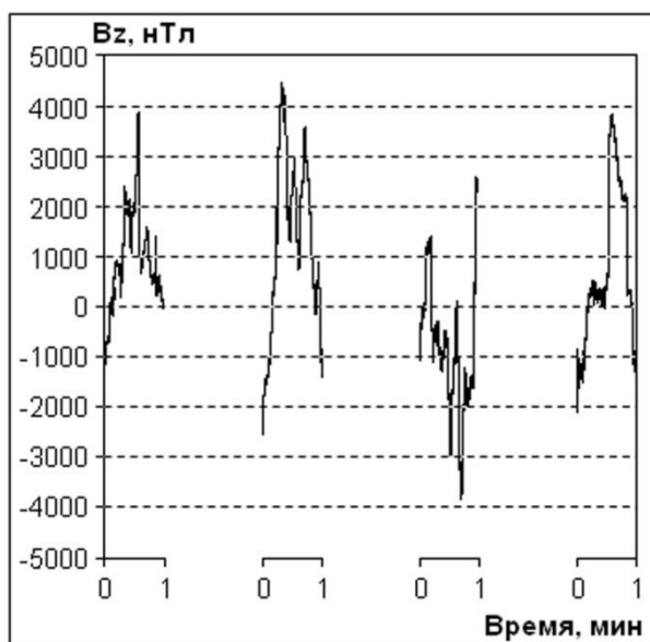
Рис. 3 – Детализация минутных импульсных сигналов вертикальной составляющей фрагмента утренней записи станции метро «Геологическая»
