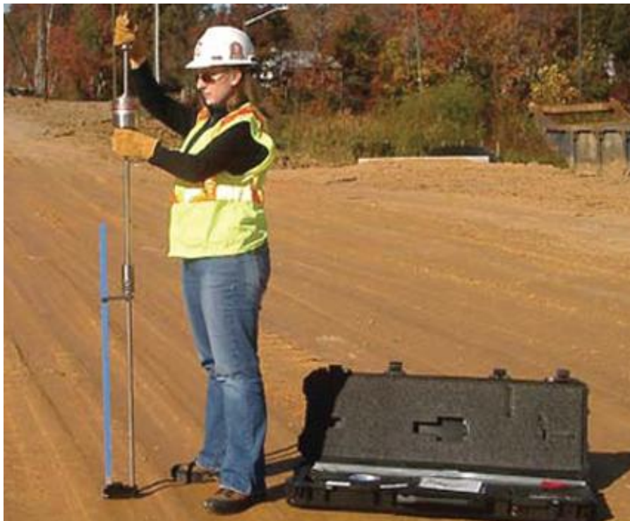
Рис. 3 – Иллюстрация испытаний грунта динамическим конусным пенетрометром DCP
