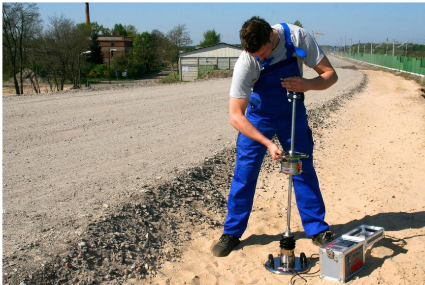
Рис. 1 – Иллюстрация испытания грунта установкой динамического нагружения ZFG 3000 GPS к испытанию
