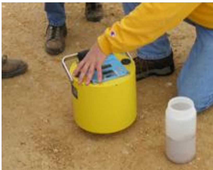
Рис. 2 – Испытание измерителем жесткости GeoGauge
