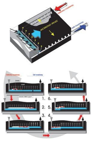
**Figure 4:** Layout of the longwall face with separate phases of coal extraction<sup>4</sup> **Slika 4:** Izgled širokega čela z ločenimi fazami izkopavanja premoga<sup>4</sup>
