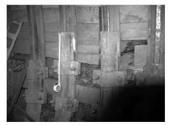
Figure 7: Damages on K24 support after a rock burst Slika 7: Poškodbe na podporju K24 po hribinskem udaru
