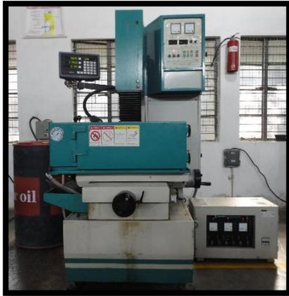
Figure 1 : Experimental die sink EDM
