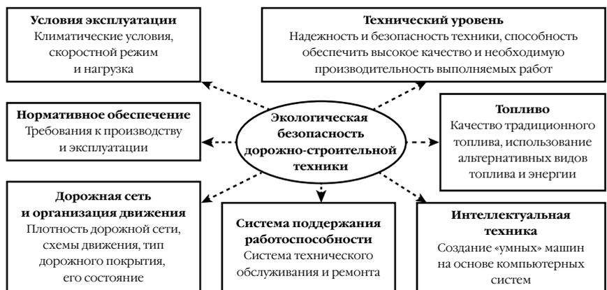
Рис. Экологическая безопасность дорожно-строительной техники
