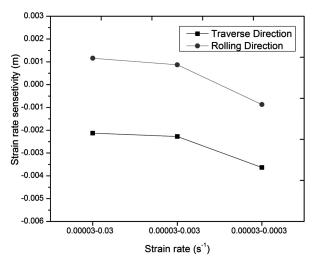
Figure 7: Strain rate sensitivity – strain rate relation Slika 7: Odvisnost: občutljivost na hitrost obremenjevanja – hitrost obremenjevanja
