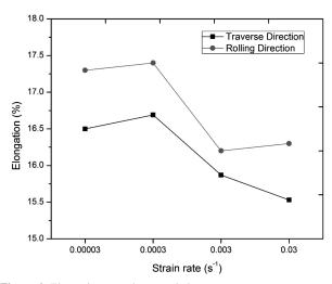
Figure 4: Elongation – strain rate relation Slika 4: Odvisnost raztezek – hitrost obremenjevanja
