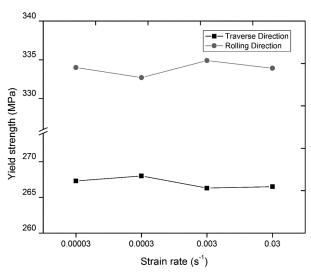
Figure 2: Yield strength – strain rate relation Slika 2: Odvisnost meja plastičnosti – hitrost obremenjevanja
