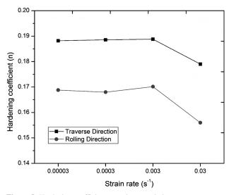
Figure 5: Hardening coefficient – strain rate relation Slika 5: Odvisnost med koeficientom utrjevanja in hitrostjo obremenjevanja
